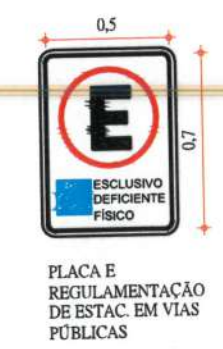
05 | DETALHE SINALIZAÇÃO VERTICAL ESCALA 1/200
