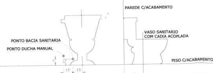
DUCHA MANUAL DETALHE BACIA SANITARIA COM CAIXA ACOPLADA
