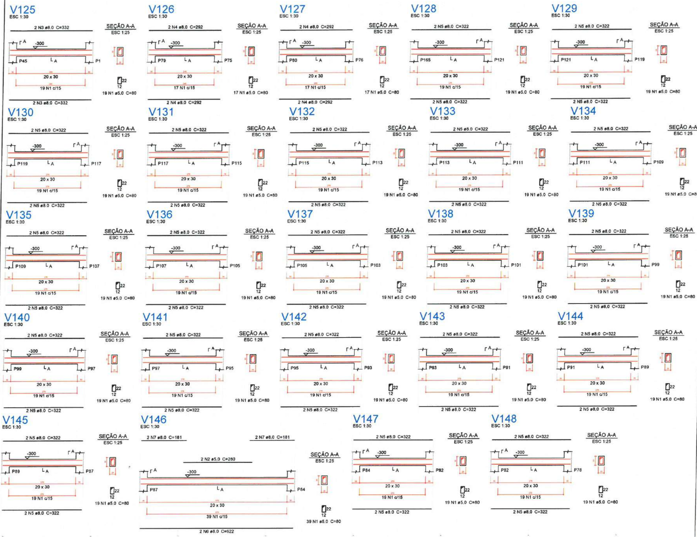
1 DETALHAMENTO DE VIGAS DA FUNDAÇÃO ESCALA: 5/E
