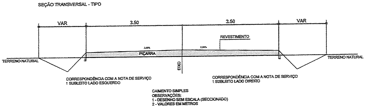
Fig. - Seção tipo da via
