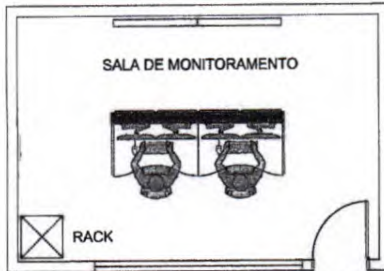
Figura 01- Layout Sala de Operação e Monitoramento
