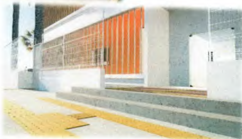
Figura 23 – Volumetria dos Acessos com Piso Tátil - SASDH (Acessibilidades conforme ABNT NBR9050 / NBR 16537)
