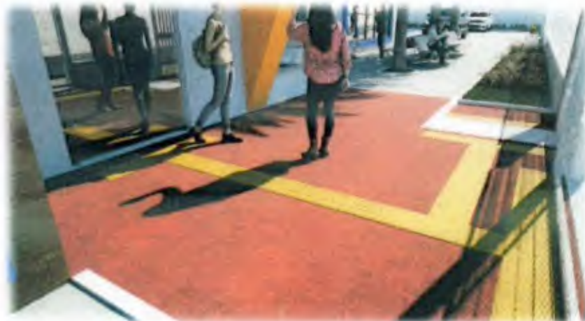
Figura 25 – Volumetria dos Acessos com Piso Tátil (Acessibilidades conforme ABNT NBR9050 / NBR 16537)
