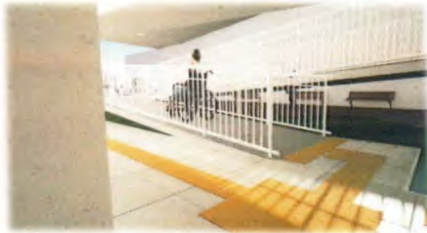
Figura 25 – Volumetria dos Acessos com Piso Tátil (Acessibilidades conforme ABNT NBR9050 / NBR 16537)
