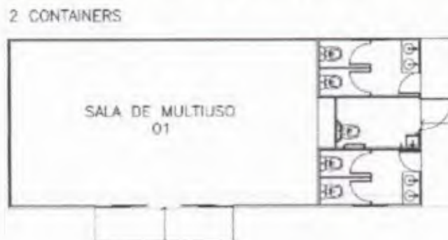
Imagem 17- Planta baixa do bloco de sala multiuso.
