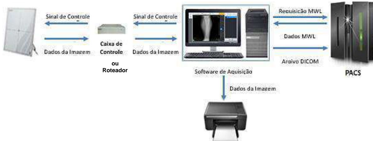
Figura 63 – Fluxo do Processamento de Imagem
