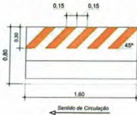
Figura 16 – Barreira de Canalização
