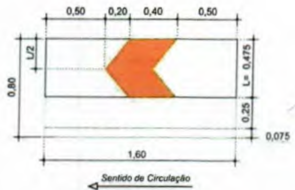
Figura 15 – Barreira de Canalização
